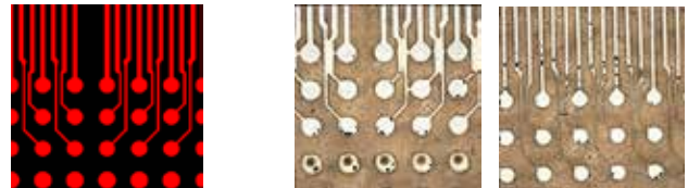
Abbildung 5: Ätzergebnis einer Ball-Grid-Array-Entflechtung mit konstantem Ätzvormaß, links: Layoutdaten, Mitte: Kurzschlüsse durch zu große Maßzugabe, rechts: zu schmale Leiter durch zu wenig Maßzugabe (dunkle Punkte in Grafiken sind aufnahmebedingte Fehler)
