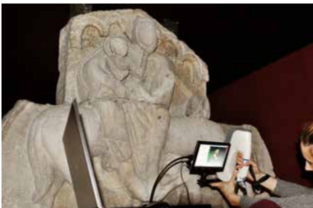
Abbildung 2: Der Scanvorgang mit dem handgeführten Artec® Eva® 3D-Scanner.
