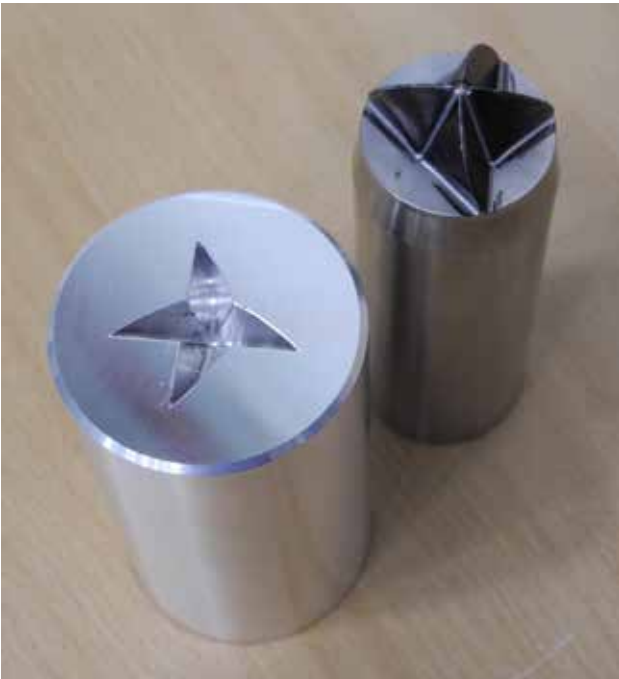
Abbildung 4: Zentrierkavität in einer Welle und konturierte Zentrierspitze
