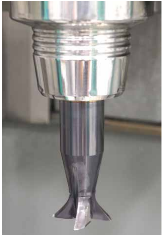
Abbildung 3: Profil-Schaftfräser, d_c = 28,8 mm, TiAlN beschichtetes HSS
