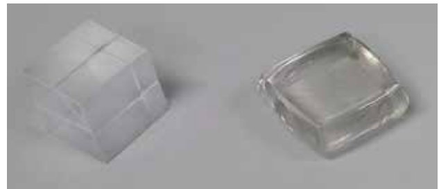
Abbildung 4a: Wafer - hergestellt aus kubischer Preform
