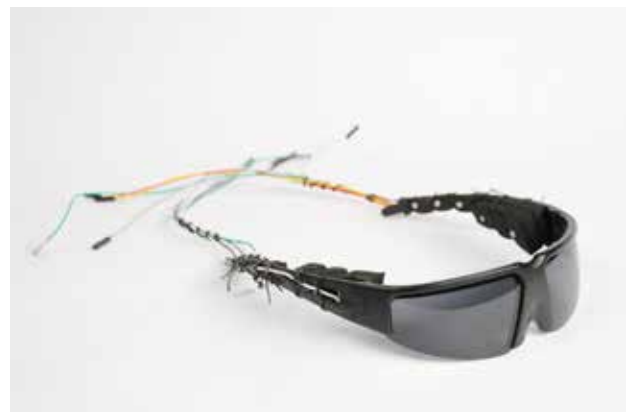
Abbildung 6: Funktionierender Prototyp einer Sonnenbrille mit integrierten EEG-Elektroden
