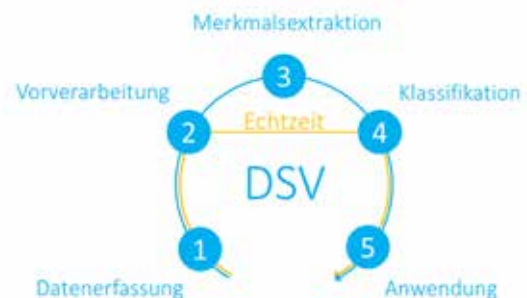
Abbildung 2: Typische Prozesskette der digitalen Signalverarbeitung (DSV) eines Brain-Computer-Interfaces
